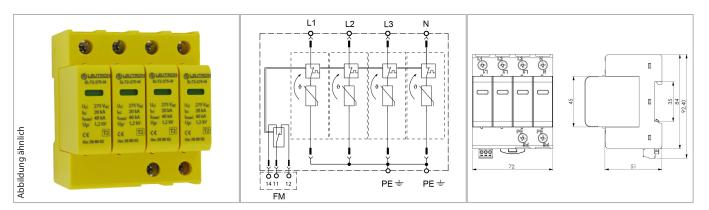
Durchgängig steckbarer Überspannungsableiter Typ 2 für dreiphasige TNS-Systeme. Komplettmodul in 4+0-Schaltung.
