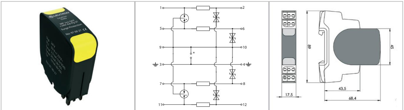
Durchgängig steckbarer, zweiteiliger Kombi-Ableiter für Signalkreise, wodurch Stecker für Prüf- und Wartungszwecke impedanzneutral gezogen werden kann. Das Basisteil verbleibt in der Installation, wodurch nicht in die Verkabelung eingegriffen werden muss.
