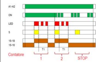
Beispiel 1: Funktion E, Zähler-Preset = 2.
