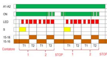
Beispiel 2: Funktion Cc, Zähler-Preset = 2.
