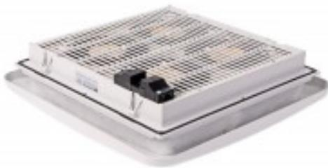
Mit einem Dachlüfter wird die warme Luft aus dem oberen Schaltschrankbereich abgesaugt und damit ein Wärmestau verhindert. Die Montage und Filterwechsel kann ohne Werkzeug erfolgen, Man benötigt die gleichen Montageausschnitte wie bei der Filterlüfterserie LV, und kann diese auch kombinieren. Als Lufteintritt sollte ein Filter im unteren Bereich des Schaltschranks eingebaut werden.
