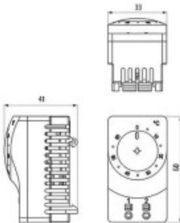
KTS 60: Schließer (NO) zur Regelung von Filterlüftern, Wärmetauschern, Kühlgeräten oder zum Schalten von Signalgebern bei Temperaturüberschreitung. Der Kontakt schließt bei steigender Temperatur.
